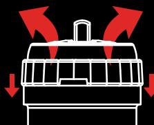
DEPRESSING THE VALVE CAP AGAINST THE SPRING ACTIVATES THE QUICK-RELEASE MECHANISM AND RELEASES THE VACUUM
